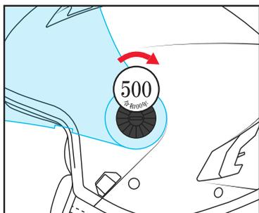
3. シールドピボットをコインドライバー等を使用して取り付けます。
