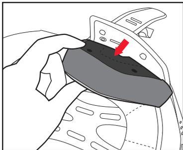
1. チークパッド内側のスナップ(2点)を取り外し、引き抜きます。
