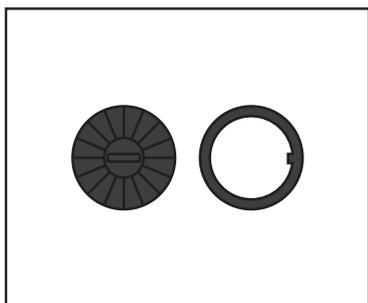
4. シールドピボットはピボット・ワッシャーの2つで構成されています。
