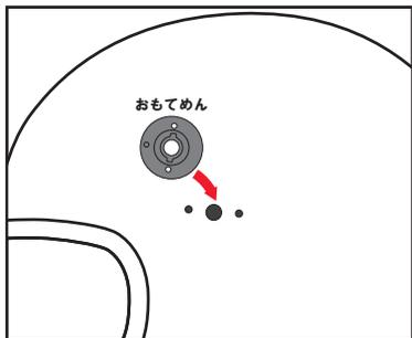
1. シールドピボットベース表にある突起を前方にし、ベース裏の突起とシールドの穴を合わせて取り付けます。
