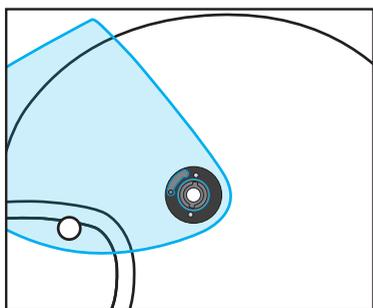
2. シールドの穴とシールドピボットベース表の突起を合わせ、はめ込みます。
