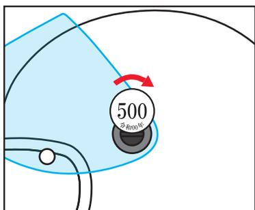
4. コインドライバー等を使用してピボットを取り付けます。
