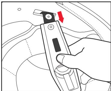
1. チークパッドを外し、スナップ(1点)を取り外して、ベルトサポートを抜き取ります。
