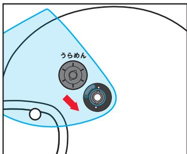
3. シールドピボットベースと台座裏面の凹凸を合わせてはめ込みます。
