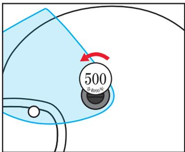
2. シールドピボットをコインドライバー等を使用して取り外します。
