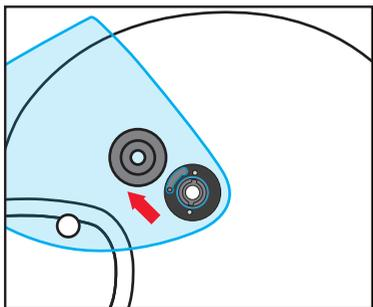
3. ピボットを外したら、台座を取り外します。
