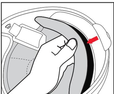
3. センターパッド後方のツメを引き抜きます。
